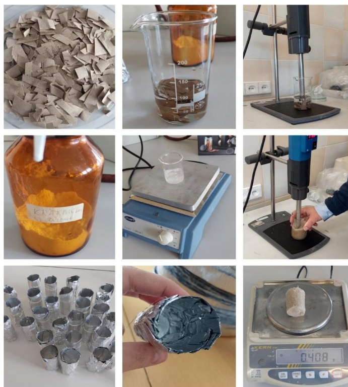
1 pav. Aerogelių ruošimo eiga laboratorijoje iš kairės į dešinę viršuje tirpalo iš celiuliozės atliekų ir distiliuoto vandens paruošimas, viduryje krakmolo tirpalo, ištirpinto karštame distiliuotame vandenyje paruošimas, apačioje galutinio tirpalo išpilstymas į folines formeles ir aerogelio struktūra
